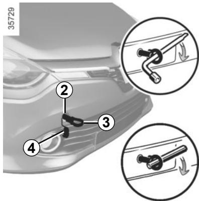
Utilice exclusivamente los puntos de remolcado delanteros **2** y traseros **5** (nunca los tubos de transmisión o cualquier otra parte del vehículo).
