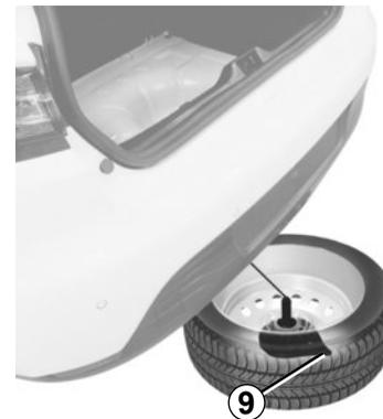
Después de cambiar una rueda, coloque la rueda que ha desmontado en el soporte **8**, válvula hacia el suelo. Enganche el cable **6** en su alojamiento **7** y después empuje la rueda hasta que quede debajo del maletero.
